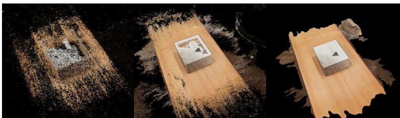
Obrázok 2.13. Tie Points – vľavo, Point Clouds – v strede, hotový model – vpravo (Czakóová, 2020; Takáč, 2020).
