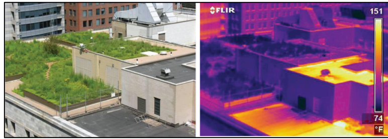
Obrázok č. 2 Meranie termovíznou kamerou
