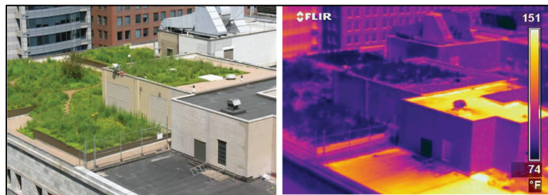
Obrázok č. 2 Meranie termovíznou kamerou
