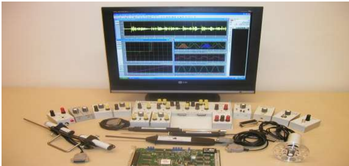
Obr. 2 ISES: Hardvér s hlavným panelom, spojovacím panelom a neúplnou súpravou modulov
